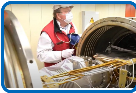
Монтаж и вакуумные испытания пучковой камеры Бустера // Installation and vacuum tests of the Booster beam pipe
